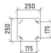
**3 - Fixer les tiges de scellement :** Sceller 4 tiges filetées M12 x 250 mm en acier inoxydable avec du mortier chimique. Fixer la platine sur 4 contre-écrous de réglage de niveau et verrouillé par 4 écrous de serrage
