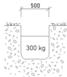
**2 - Percer le béton :** Utiliser le gabarit d'un forex pour réaliser 4 perçages sur le massif béton en respectant un entraxe de 175 mm. Utiliser une mèche béton de Ø15 mm et percer sur 300 mm de profondeur. Souffler la poussière.
