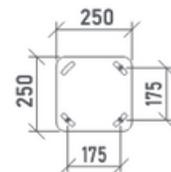
**3 - Befestigen der Gewindestangen:** Versiegeln Sie 4 Gewindestangen M12 x 250 mm aus rostfreiem Stahl mit chemischem Mörtel. Befestigen Sie die Fussplatte auf 4 Kontermuttern zur Niveauregulierung und verriegeln Sie mit 4 Spannmuttern.
